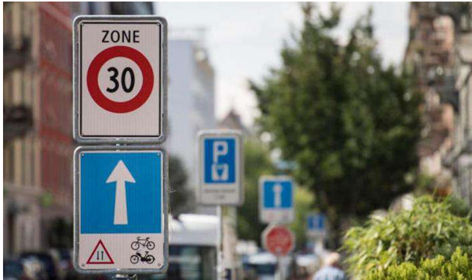
Εικόνα 2. Παράδειγμα κατακόρυφης σήμανσης προειδοποίησης μειωμένης ταχύτητας
